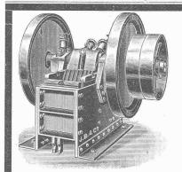
Ia Maschinen, mit selbsteinstellbaren Bruchsicherheitsplatten, die jeden Bruch vollständig ausschliessen stationär und fahrbar
