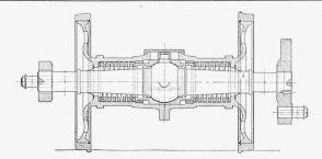
Abb. 1. Hohltriebachse (nach Klien-Lindner) der Ae4/4 Simplon-Lokomotive.
