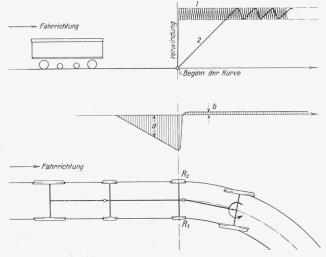
Abb. 2. Verhalten des Kardan-Untergestells in einer Kurveneinfahrt und in der Kurve.
