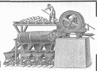
Steinbrecher mit Sortiertrommel.
