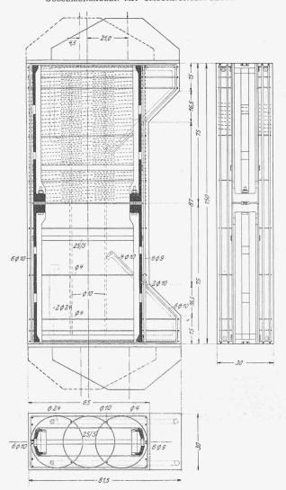
Abb. 4. Versuchkörper, in halbem Masstab, für den Versuch 1.
