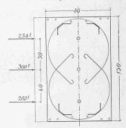
Abb. 3. Gefährlicher Querschnitt aus dem Vorprojekt.
