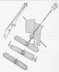
Abb. 8. Kräfte- und Randspannungen im I. Widerlager.
