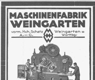
Vereinigte Lochstanze, Blech-u. Profileisenschere in Stahlformguss
