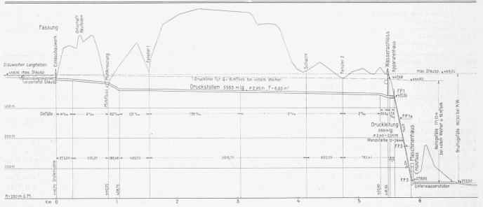
Abb. 2. Längenprofil der Wasserkraftanlage Partenstein an der grossen Mühl. – Masstab der Längen 1:4000, Masstab der Höhen 1:4000.
