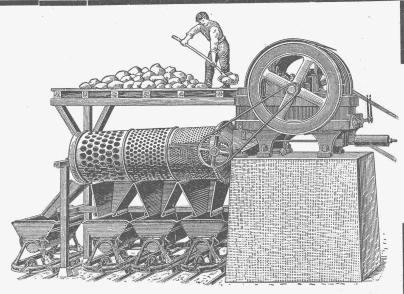
Steinbrecher mit Sortiertrommel.
