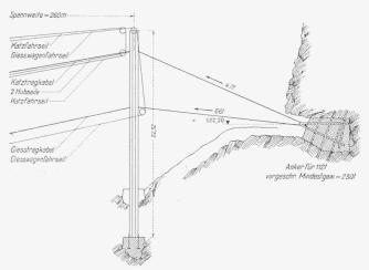
Abb. 11. Fester Abspannturm (im Wäggital rechtsufrig) 1:400.
