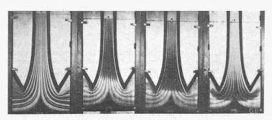
Abb. 3. Laminare Saugrohrströmungen, ohne Zeitkurven.
