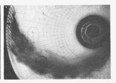
Abb. 13. Ausbildung der Turbulenz bei spiraliger Strömung im polaren Netz.
