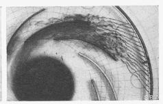
Abb. 7. Strömungen zwischen Leitradschaufeln: Schaufeln aus Blech, ohne Zeitkurven. - Farbstoffzuführung bei Abb. 7 bis 10 in mittlerer Höhe.
