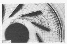
Abb. 10. Strömungen zwischen Leitradschaufeln: geformte Schaufeln, mit Zeitkurven.
