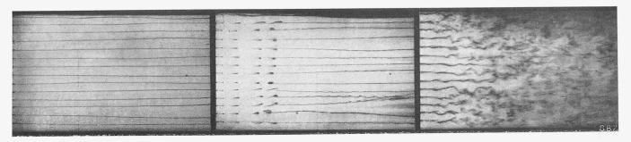
Abb. 11. Ausbildung der Turbulenz bei geradliniger Parallelströmung.
