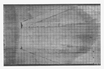
Abb. 6. Strömung im Kanal mit Rechteckprofil, mit Zeitkurven.
