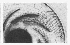
Abb. 8. Strömungen zwischen Leitradschaufeln: Schaufeln aus Blech, mit Zeitkurven.
