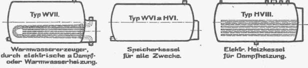
Warmwassererzeuger, durch elektrische a Dampf- oder Warmwasserheizung. Speicherkessel für alle Zwecke. Elektr. Heizkessel für Dampfheizung.
