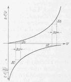
Die Leistungsfähigkeit eines Ablaufrückens ist abhängig von der zulässigen Abdrückgeschwindigkeit, dann vom "Pufferzeitabstand", der so gross sein muss, dass zwischen zwei Wagen oder Wagengruppen die Weichen umgestellt werden können (4 sek).
