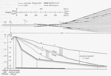
Abb. 14. Geschwindigkeitskurven einer Ablaufanlage. (Nach "Z. V. D. I." 1924, Nr. 38.)
