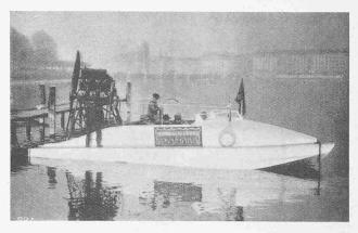
Abb. 1. Gleitboot der "S. A. des Hydro-Glisseurs Dumond-Galvin", Paris. Tragkraft 15 Personen; 80 PS,  $v=40~{\rm km/h}$ .
