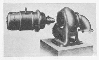
Abb. 2. Anlage mit Spiralturbine, zerlegt.
