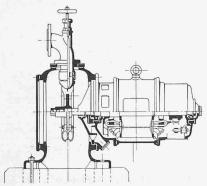
sparnis besonderer Akkumulatoren - Batterien u. dgl. Solche Aggregate für unbedienten Betrieb, ohne weiteres Zubehör werden von Maschinenfabrik der Esslingen ausgeführt auch für grössere Leistungen, wobei mit wach-Abb. 3. Anlage mit Freistrahlturbine, Schnitt. sender Grösse anstelle der Flanschdynamo der normale Zusammenbau auf gemeinsamer Platte mit der Turbine
