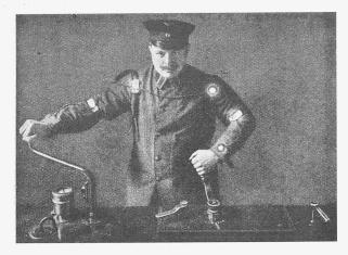
Abb. 1. Ausrüstung eines Wagenführers für die gewöhnliche Punktbewegungsphotographie. Die Abbildungen 2 bis 5 auf der nebenstehenden Seite sind nach dieser Methode aufgenommene Bewegungsbilder.
