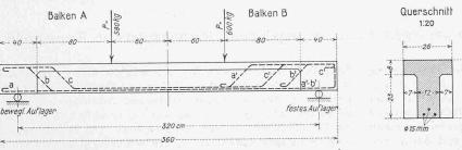
Abb. 2. Längsansicht (1:40) und Querschnitt (1:20) der auf Dauerbelastung untersuchten Balken.
