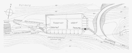
Abb. 1. Lageplan des Ausgleichbeckens auf dem Rütigberg oberhalb Näfels. - Masstab 1:1000.
