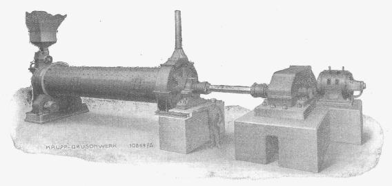
Mehrkammer-Verbund-Rohrmühle mit Centra-Antrieb
