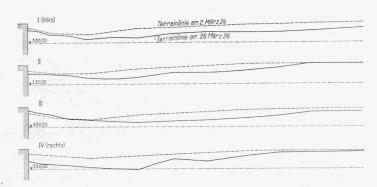
Abb. 2. Aufnahmen des Kolkes am Wehr des Kraftwerks Chancy-Pougny unterhalb der Sehwellen der vier Oeffnungen.
