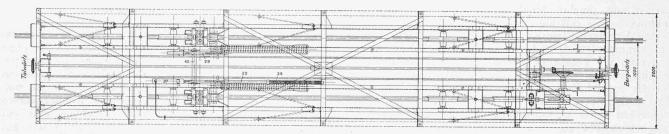
Abb. 10. Seitenansicht des Wagens der I. Sektion der Seilbahn Lugano - San Salvatore und Draufsicht auf dessen Untergestell. - Masstab 1:60.
