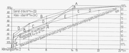
Abb. 1. Granulometrische Zusammensetzung der Kies-Sand-Gemenge A bis E.
