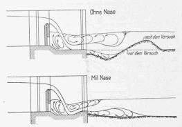
Abb. 3. Modellversuche über Kolkbildung am Wehr Chancy-Pougny ohne und mit Erhöhung der untern Wehrschwellenkante.
