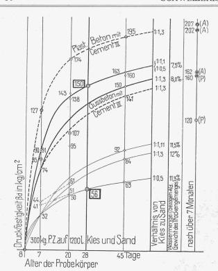
Untersuchungen über die Eignung von Kies-Sand-Gemengen zu Beton- und Eisenbetonzwecken.
