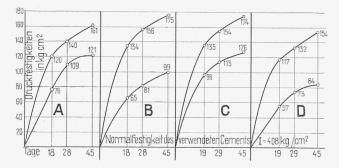
Abb. 2 (links). Erhärtungskurven des Beton, hergestellt mit den Kies-Sand-Gemengen A bis D; untere Kurve mit dem natürlichen Gemenge, obere Kurve mit einem Verhältnis 2:1 von Kies zu Sand.
