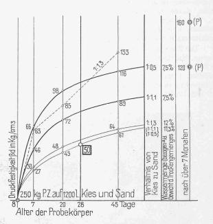
Abb. 4 und 5. Erhärtungskurven des Beton, hergestellt aus dem Kies-Sand-Gemenge E, links mit 300 kg, rechts mit 250 kg Portland-Zement auf 1200 l Kies und Sand.
