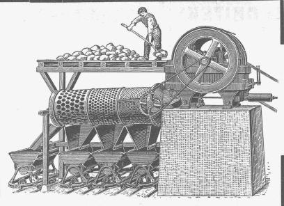
Steinbrecher mit Sortiertrommel.
