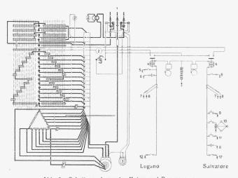
Abb. 9. Schaltungschema der Motor- und Bremsgruppe. LEGENDE: 1 Automatischer Schalter; 2 Schalter kombiniert mit der automatischen Bremse; 3 Bremsläftmagnet; 4 Relais; 5 Abfahrtsignal; 6 Endausschalter; 7/8 Signal- und Notausschaltung vom Wagen aus; 9 Erstes Vorsignal; 10 Zentrifugal-Auslösung; 11 Zweites Vorsignal; 12 Abfahrtsignal.
