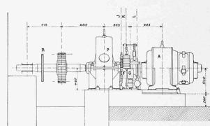
Abb. 7. Motor- und Bremsgruppe in der Mittelstation. Grundriss und Ansichten 1:50.
