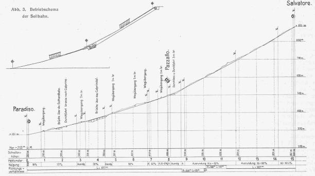
Abb. 2. Längenprofil der Seilbahn von Lugano-Paradiso auf den Monte San Salvatore. — Masstab der Längen und Höhen 1:10000.
