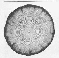
Abb. 2, Schnitt durch ein nach dem Einlaugeverfahren imprägniertes Rundholz.
