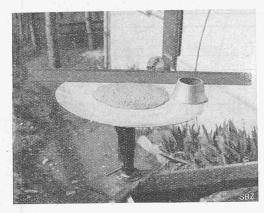
Abb. 7. Plastischer Mörtel. Der Mörtel entmischt sich nicht, trotz des Flüssigkeitsgrades F=2,0; (Z+S) enthält $_2^145^0/_0<0,5$  mm.
