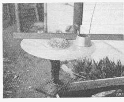
Abb. 8. Unplastischer Mörlel. Am Kuchenrand ist ausgeschiedene Zementmilch sichtbar. F=2,0; (Z+S) enthält 25% < 0,5 mm.
