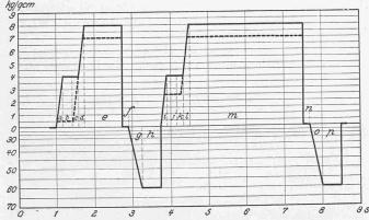
Abb. 1. Druckkurve beim Imprägnieren von Rotbuchholz mit Teeröl; bei c und j Füllen des Tränkkessels mit Oel unter Beibehaltung des Luftdrucks, bei f und n Abl.ssen des Oels vor Herstellung des Vakuums.
