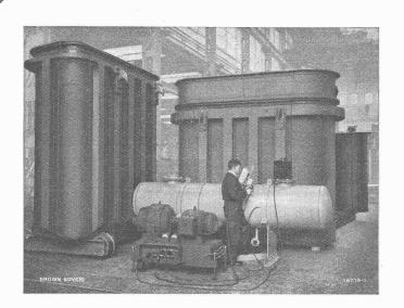
Mit Brown Boveri Lichtbogen-Schweißgruppen elektrisch geschweißte Groß-Transformatorenkessel.
