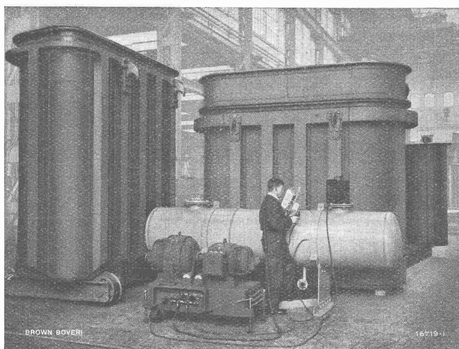
Mit Brown Boveri Lichtbogen-Schweißgruppen elektrisch geschweißte Groß-Transformatornkessel.
