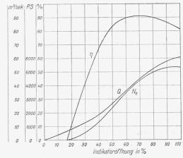
Abb. 1 und 2. Ergebnisse der Abnahmeversuche an zwei Turbinen des Kraftwerks Laufenburg im Juli 1915. Konstruktionsdaten: H=8 m, Q=60 m $^8/s$ ck, N=5000 PS, n=107 Um $^1/m$ in.
