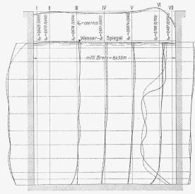
Abb. 3 und 4. Ergebnisse doppelter Flügelmessung im Einlauf der Turbine Nr. 1 (links) und 3 des Kraftwerks Laufenburg. Wirkungsgrad der Turbinen 90,1%0, bezw. 91,0%0. Wirkungsgrad der Turbinen 90,4%0, bezw. 91,5%0.
