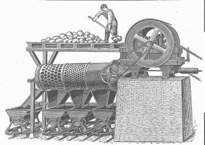
Steinbrecher mit Sortiertrommel.
