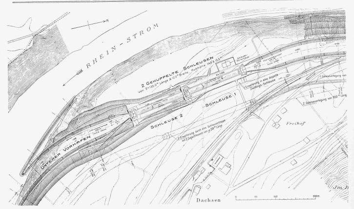
Abb. 33. Zweistufige Schleusentreppe zur Ueberwindung der Rheinfall-Stufe. (Anschluss rechts nebenan) - Masstab 1:4000.
