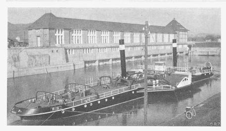
Abb. 12. Turbinen-Schleppdampfer "Zürich" der "S. S. G." Basel. Entwurf und maschinelle Ausrüstung von Escher Wyss & Cie., Zürich. — Maschinenstärke 1100 PSi.
