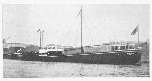
Abb. 14. Doppelschrauben-Dieselmotor-Eilgüterboot "Jupiter" der "Rhenus"-Transportgesellschaft in Basel. Länge 67 m, Nutzlast 700 t. Maschinenstärke 2×240 PS», absolute Geschwindigkeit 16,6 km/h bei 2,2 m Tiefgang.
