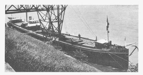
Abb. 13. Eilgüter-Dieselmotorboot "Helvelia" der Schiffsagentur "Roba" A.-G., Basel. Länge 62 m, Breite 7,07 m, Tragfähigkeit 685 t. Zwei Deutzer-Dieselmotoren zu je 200/220 PS.
