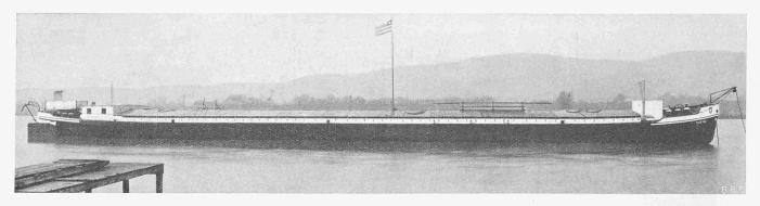
Abb. 8. Rheinkahn "Tamina" für 844 t Tragfähigkeit. Gebaut von Buss A.-G. in Augst für die "S. S. G." Basel.
