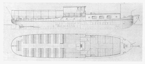
Abb. 11. Doppelschrauben-Diesel-Schlepper "Vogel Gryf" der "Basler Rheinschiffahrts A.-G." für 180 PS. und nur 0,75 m Tiefgang für Schleppdienst im Basler Hafengebiet und Personenbeförderung. — Masstab 1:200.
