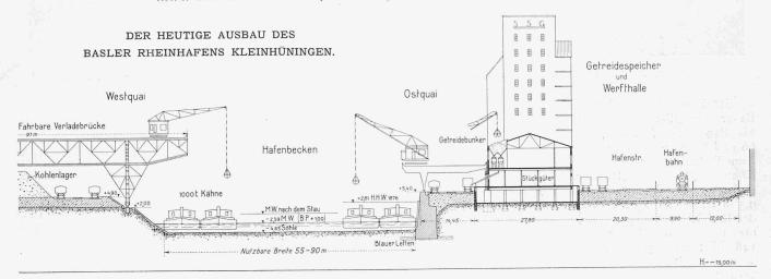
Abb. 4. Schnitt durch das erste Hafenbecken Kleinhüningen und die "Werfthalle" der Schweizer. Schleppschiffahrls-Genossenschaft. — 1:1000.
