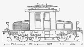
Abb. 1. Typenskizze der Sihltalbahn-Lokomotive. - Masstab 1:120.
