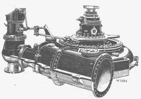
Wasserturbine für das Kraftwerk Wäggital
