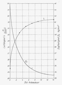
Abb. 1. Beziehung zwischen Leitfähigkeit und Zugfestigkeit bei "Drahtlegierung 3".
