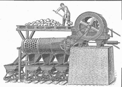
Steinbrecher mit Sortiertrommel.
