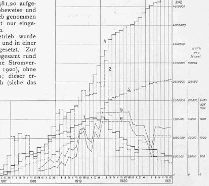
Abb. 46. Energieverbrauchs Diagramm für den Bau des Kraftwerks Mühleberg.
