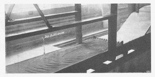
Phot. Abb. 1. Modellversuch für Friedland, mit Zahnschwelle. - Modellmasstab 1:40 - Aus dem Kailsruher Flussbau-Laboratorium.
