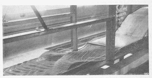
Phot. Abb. 3. Modellversuch für Friedland, ohne Zahnschwelle. — Modellmasstab 1:40.
