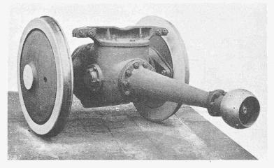
Abb. 5. Triebachse des Motorwagens mit der Triebdeichsel.
