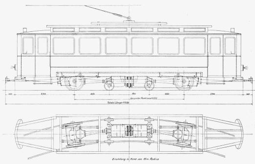
Abb. 2. Ansicht und Untergestell-Draufsicht eines zweiachsigen Motorwagens der Städt. Strassenbahn Zürich, versehen mit dem neuen Antriebsgestell der Schweizer. Lokomotivfabrik Winterthur. — Masstab 1:80.
