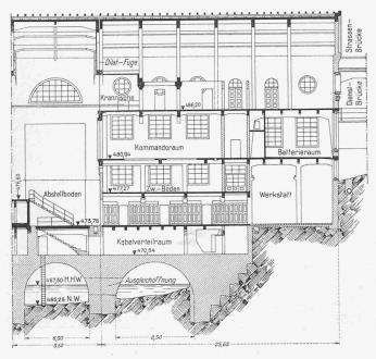
Abb. 19. Längsschnitt durch den Maschinenhausanbau. - 1:400.
