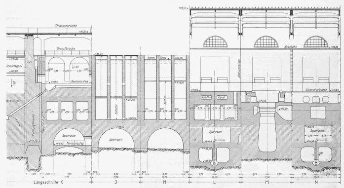
Abb. 18. Abgetreppter Längsschnitt durch Turbineneinläufe und Maschinenhaus (vergl, den Querschnitt Abb. 15). – Masstab 1: 400.
