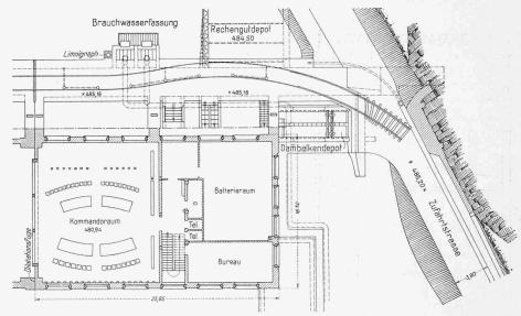
Abb. 22. Maschinenhausanbau-Horizontalschnitt über Kote 480,94. — Masstab 1:400.
