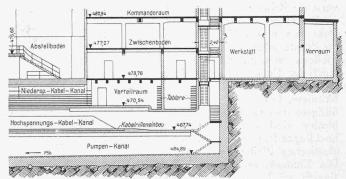
Abb. 20. Längsschnitt durch den Maschinenhausanbau in der Ebene der Pumpen- und Kabelkanäle, — Masstab 1:400.
