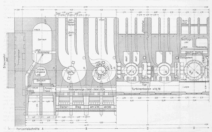
Abb. 16. Von unten (links) nach oben, bis auf Generatorboden (rechts) abgetreppter Horizontalschnitt. — Masstab 1:400.
