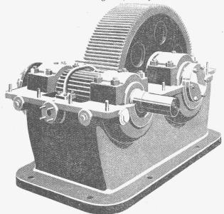
Ritzel mit gehärteten und geschliffenen Zähnen Rad mit gehobelten Zähnen 16 Getriche an eine Zementfabrik in Belgien geliefert
