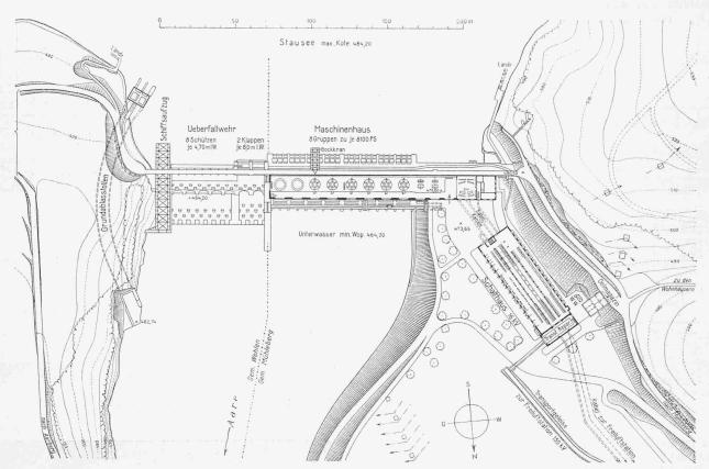
Abb. 4. Lageplan des Kraftwerks Mühleberg. — Masstab 1:2500, Kurvenabstand 5 m.
