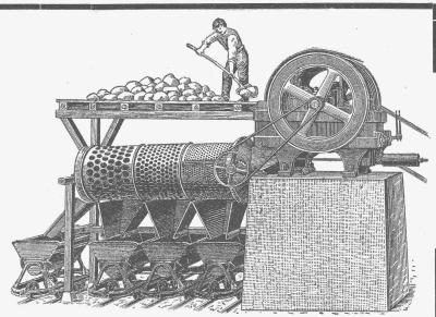
Steinbrecher mit Sortiertrommel.
