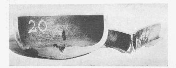
Abb. 1. Materialfehler bei nicht explodierten Behältern. Risse im Boden des Gefässes (links) und im Mantel (rechts).
