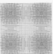
Abb. 2. Zweibahnen-System Maillart. Oben liegende Eisen dick gezeichnet.
