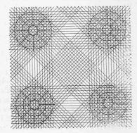
Abb. 6. Deckenarmierung nach dem Amerikanischen Vierbahnen-System.
