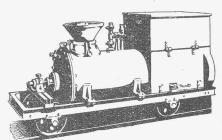
Mit dieser Cementinjectionsmaschine, & Patent,
