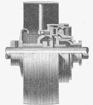
Benn-Kupplung, Typ NN, in Verbindung mit R'emenscheibe
