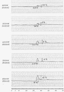
Fig. 12. Relevés tachygraphiques du fonctionnement du régulateur de la turbine d'Escher Wyss & Cic.
