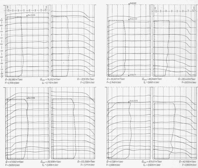
Fig. 4. Diagrammes des vitesses de l'eau pendant les essais de rendement de la turbine 2 d'Escher Wyss & Cie.
