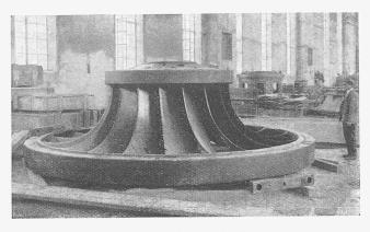
Fig. 8. Roue d'une turbine d'Escher Wyss & Cic.
