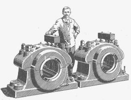
Schwere Stehlager 350 mm Bohrung mit Ring- und Zirkulationsschmierung für 360 Umdrehungen pro Minute.
