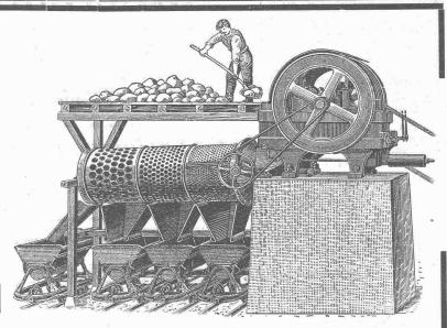
Steinbrecher mit Sortiertrommel.
