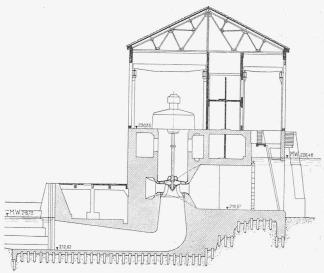
Abb. 6. Schnitt durch das Maschinenhaus des Kraftwerks Twin City.
