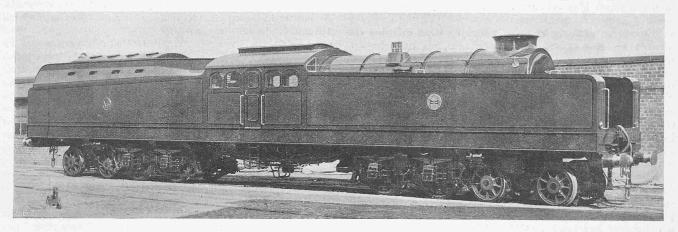
Abb. 6. Lokomotive mit turbo-elektrischem Antrieb, nach System Reid und MacLeod, der North British Locomotiv Co., Glasgow,
