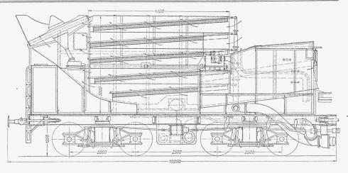
Abb. 2. Schnitt durch den Tender der Zoelly-Turbolokomotive in Abb. 1.
