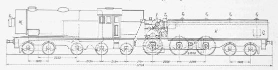
Abb. 5. Dampfturbinen-Lokomotive nach System Ljungström der Beyer, Peacock & Co., Ltd., Manchester. - Ansicht 1:150.
