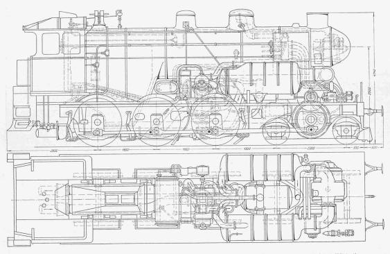
Abb. 1. Dampfturbinen-Lokomotive System Zoelly, von Escher Wyss & Cie. und der Schweizer. Lokomotivfabrik Winterthur.
