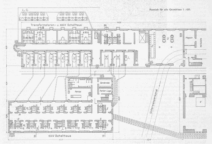
Abb. 101. Erdgeschoss-Grundrisse des 15 kV-Schalthauses, des Schaltstand-Gebäudes und des Transformatoren und 66 kV-Schalthauses.
