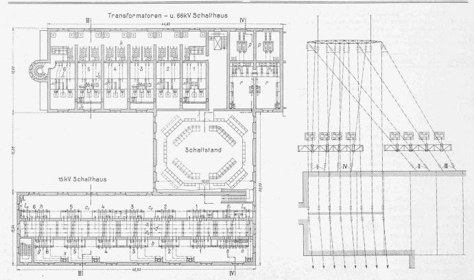
Abb. 102. Grundrisse vom I. Obergeschoss des 15 kV-Schalthauses, vom I. bezw. II. Obergeschoss des Transformatoren- und 66 kV-Schalthauses und vom III Obergeschoss des Schaltstand-Gebäudes.
