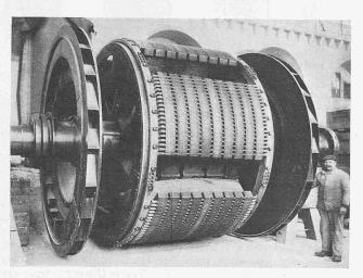
Abb. 95. Polrad mit Ventilatoren und Dämpferwicklung.
