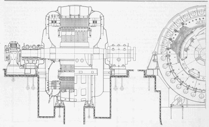
Abb. 92. Einphasenwechselstrom-Generator von 10000 kVA Dauerleistung bei cos  $\varphi=0.75,\ 333^{1/3}\ Uml/min,\ 15000\ V,\ 16^{2/3}\ Per.$  Gebaut von der Maschinenfabrik Oerlikon. — Schnitte, Masstab 1:65.
