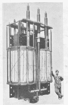
Abb. 96. 10000 kVA Transformator des Kraftwerks Amsteg Gebaut von den Ateliers de Sécheron in Genf.
